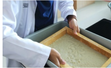
Gambar 5. Pencetakan Pulp Kertas
